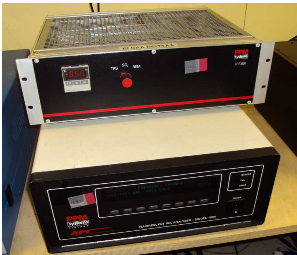
Kuva 2: Haisevat rikkijyhdisteet (TRS) mitataan Hiskinmäellä API 100 A analysaattorilla. Haisevat rikkijyhdisteet poltetaan rikkidioksidiksi korkealämpötilakonvertteria PPM-891 käyttäen.
